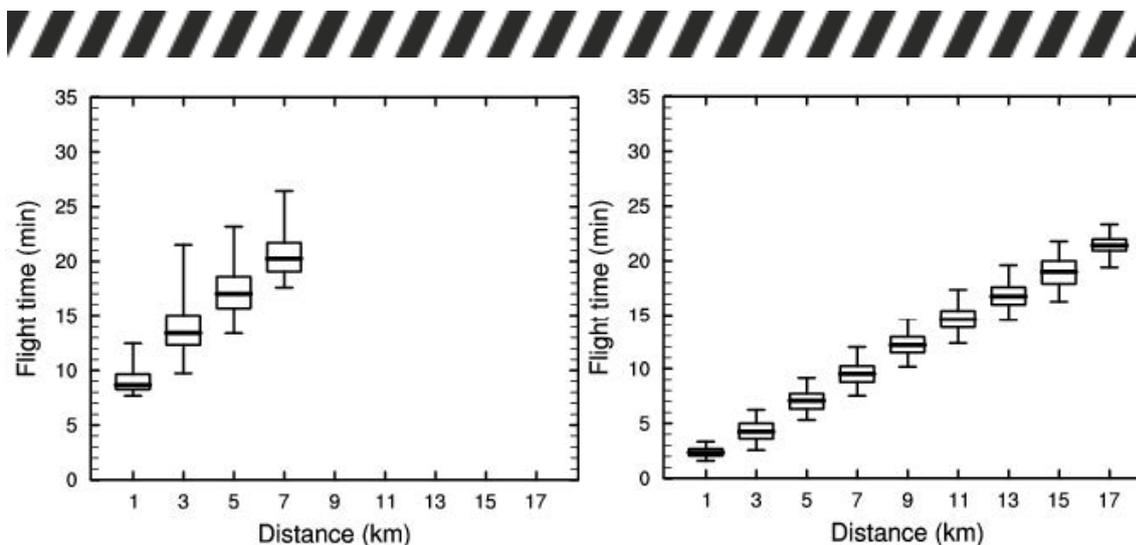
FIGURE 4. BOX AND WHISKER PLOTS OF FLIGHT TIMES FOR FIREBRANDS LOFTED BY THE TIME-VARYING PUMES UNDER BACKGROUND WIND SPEEDS OF 5 (LEFT) AND 15 (RIGHT) M S<sup>-1</sup>. FLIGHT TIMES ARE BINNED ACCORDING TO THE DISTANCE TRAVELLED BY THE FIREBRAND, AT 2-KM INTERVALS. THE THICK LINE SHOWS THE MEDIAN FLIGHT TIME AND THE BOX SPANS THE INTERQUARTILE RANGE. WHISKERS REPRESENT THE 1ST AND 99TH PERCENTILE FLIGHT TIMES.
